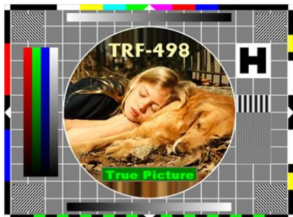
Ukázka zkušebního monoskopu a obrazce multiburst (formát 4:3, 625 řádek, 50 Hz)
